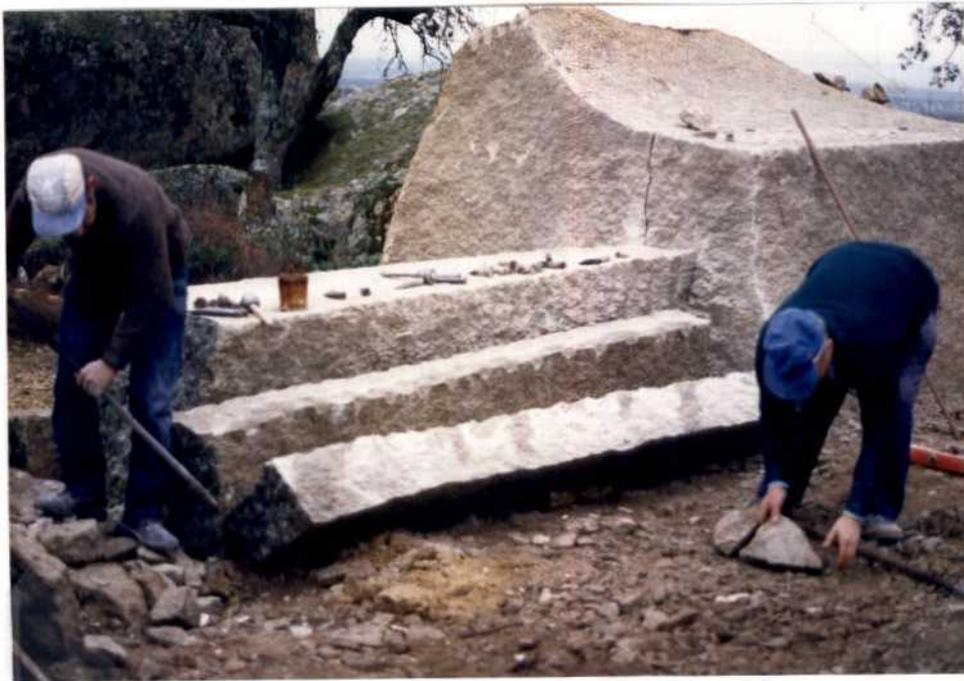
FOTOGRAFIA 3.- Extracción de bloques en la cantera de la Dehesa de Matoso (C-625-2).
